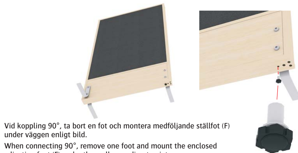
3. Om väggar skall kopplas samman används stift (D) vilka monteras 2 stycken på ena sidan av väggen i de förborrade hålen. Om väggarna inte skall kopplas samman monteras täckhatt (E) i de förborrade hålen. The pins are used for connecting the partitions together (D). Two pins are mounted on one side of the partition in the pre-drilled holes. If the partitions are not to be connected together, mount cover cap (E) in the pre-drilled holes.
